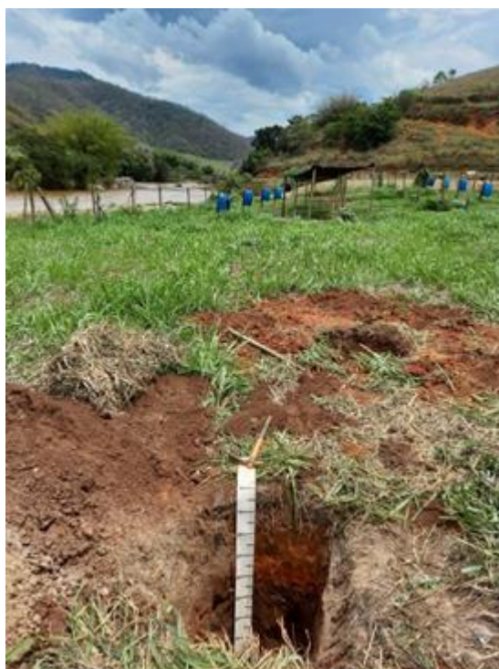
Figura 4. Inserção dos sensores de temperatura e umidade do solo.
