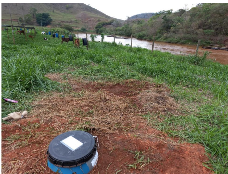
Figura 5. Fechamento do perfil de solo, e bombona parcialmente enterrada para fixação.
